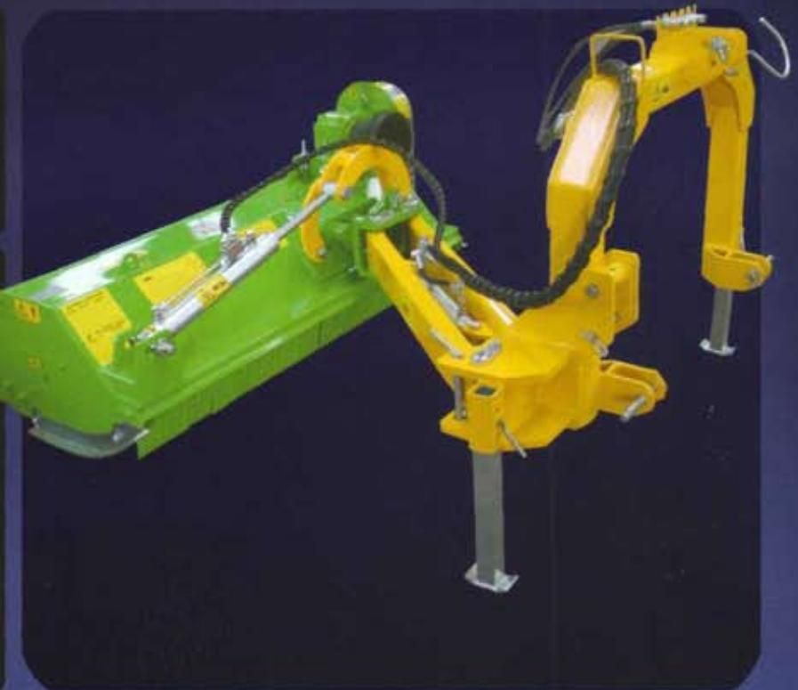
**EN/TAL** Trincatrice multiuso a lavoro laterale e posteriore, per il taglio negli argini di fossi e banchine autostradali. Può trinciare erba, vegetazione in genere, cespugli e ramaglia fino a 4 cm Ø. Da applicare a trattori con potenza compresa tra 30 e 60 HP.
